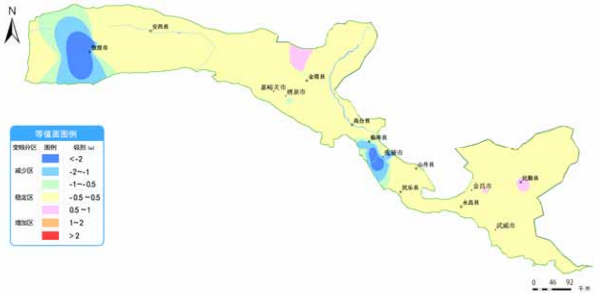
图 14 河西走廊平原 2017 年 10 月 1 日与上月同期地下水埋深变化等值面图
