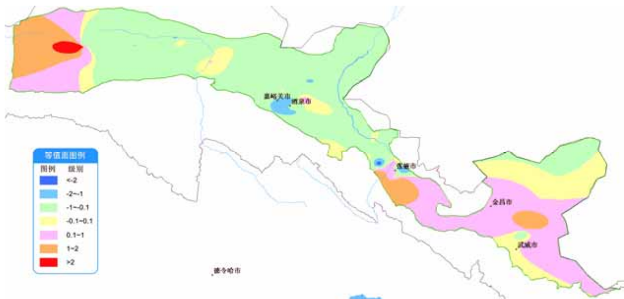
图 15 河西走廊平原 2011 年 9 月初与去年同期地下水埋深变化等值面图
