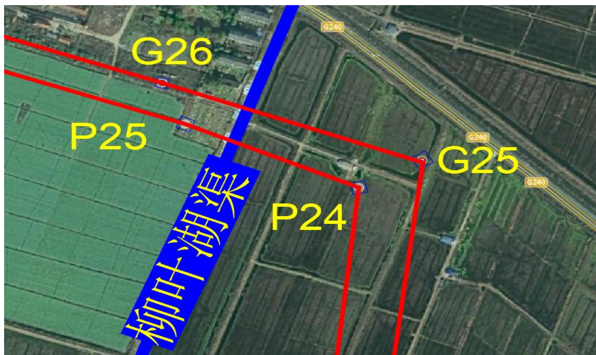
图 2.3.3.3-13 线路跨渠杆塔平面布置图
