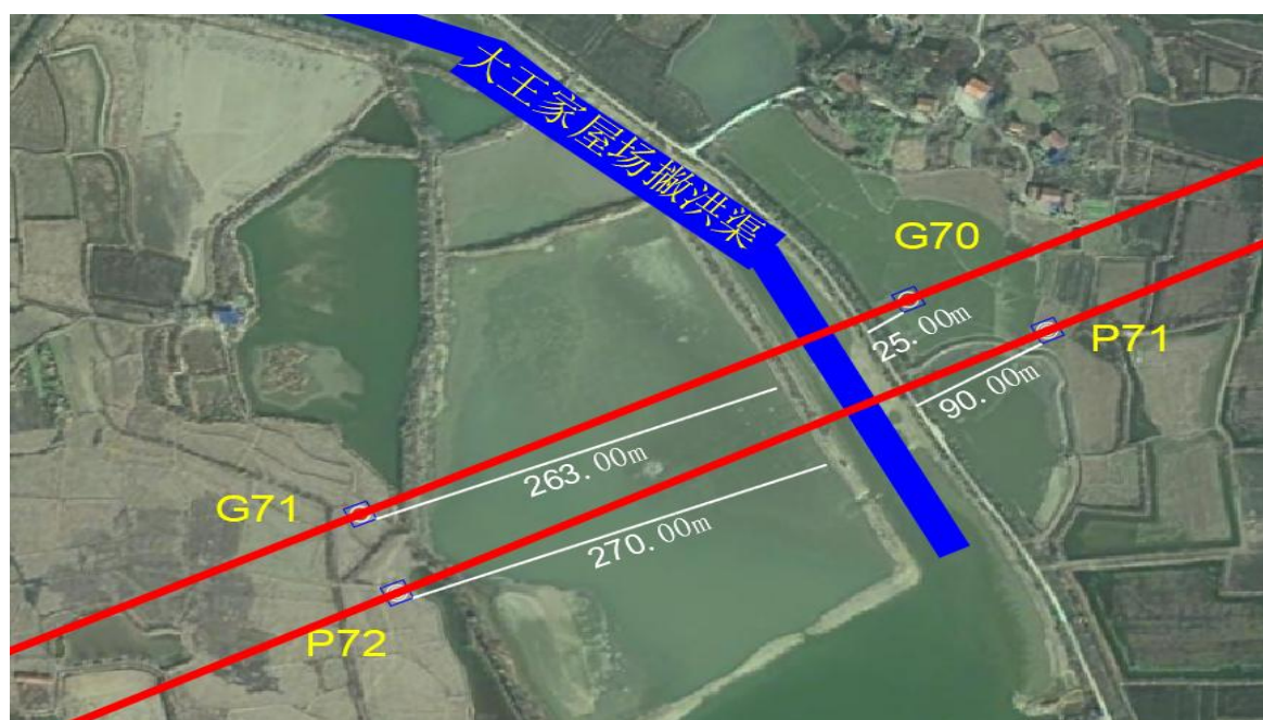
图 2.3.3.4-21 线路跨渠杆塔平面布置图
