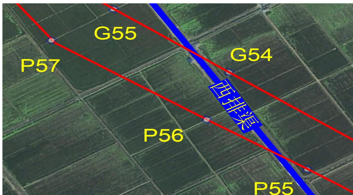
图 2.3.3.3-25 线路跨渠杆塔平面布置图
