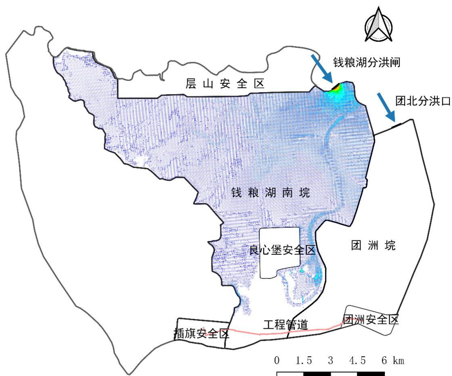
图 4.3-5 钱粮湖南垸分洪工况分洪 24h 时刻流速分布
