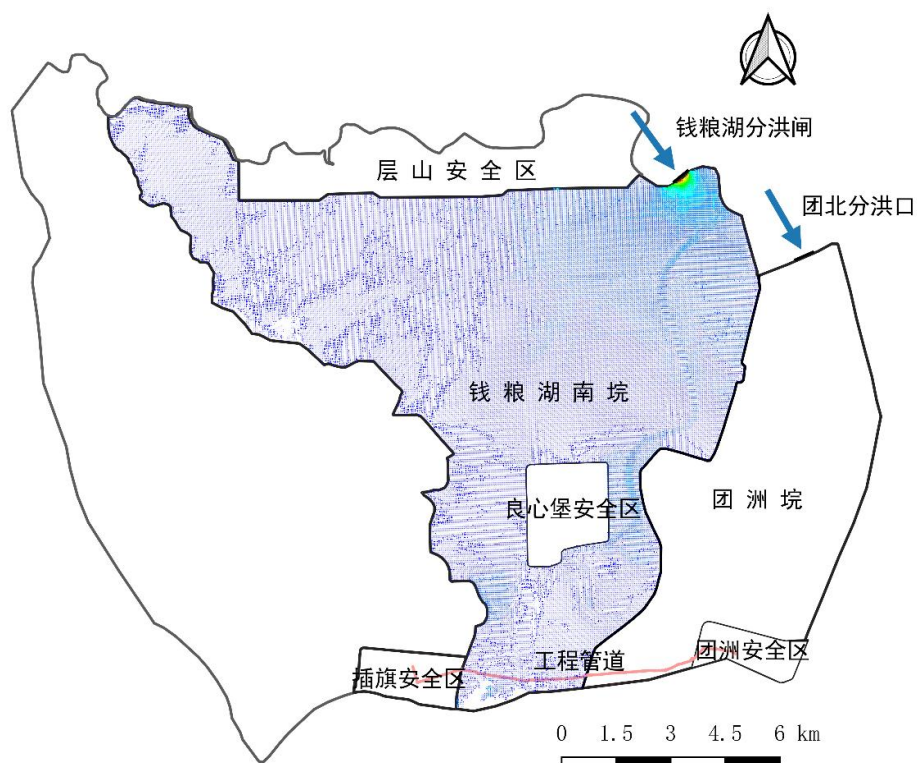
图 4.3-6 钱粮湖南垸分洪工况分洪 36h 时刻流速分布
