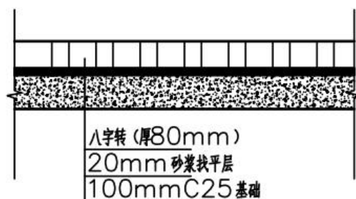
图2.2-17 停车场结构图
