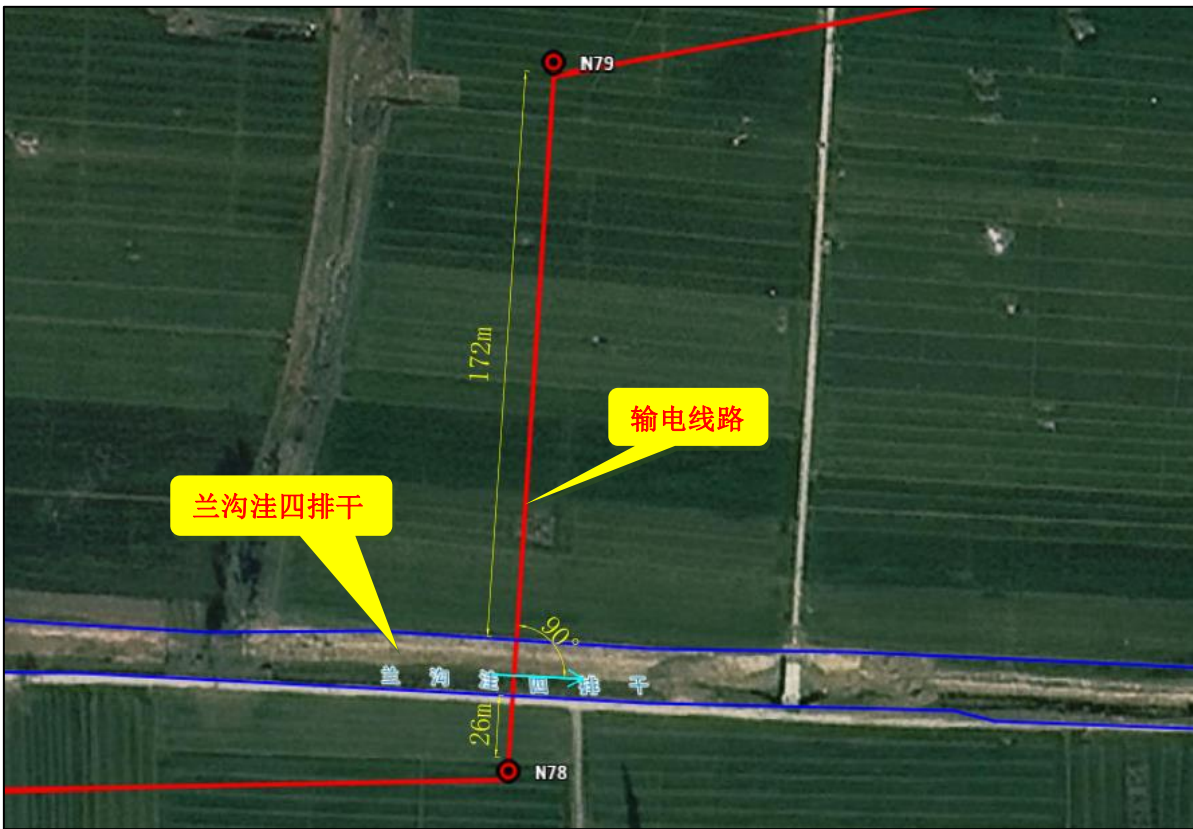
图 6.2-1 工程跨兰沟洼四排干平面图
