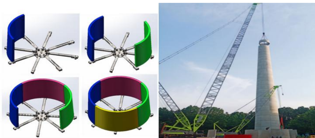
图 2.4-2 管片拼接吊装示意图
