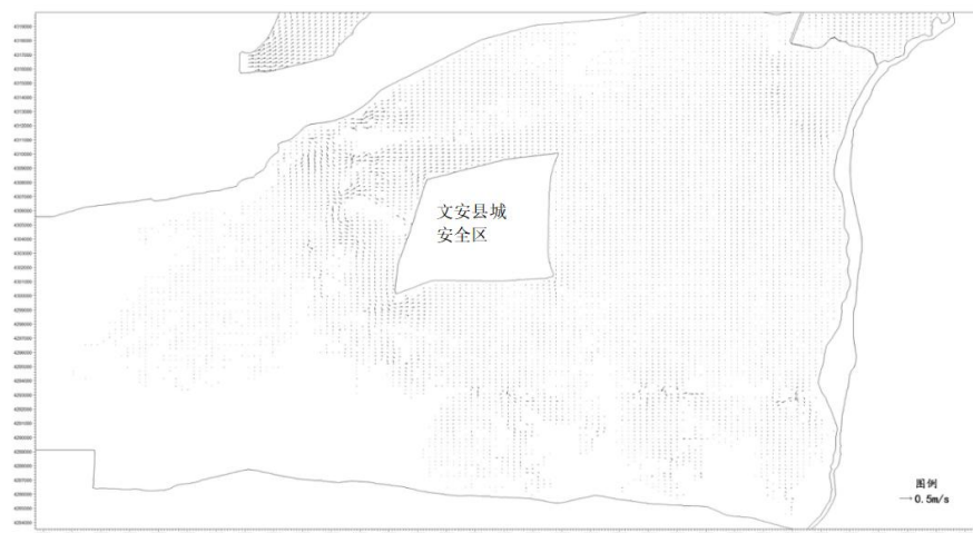
图 4.1-7 现状 100 年一遇流场图（项目建设前）
