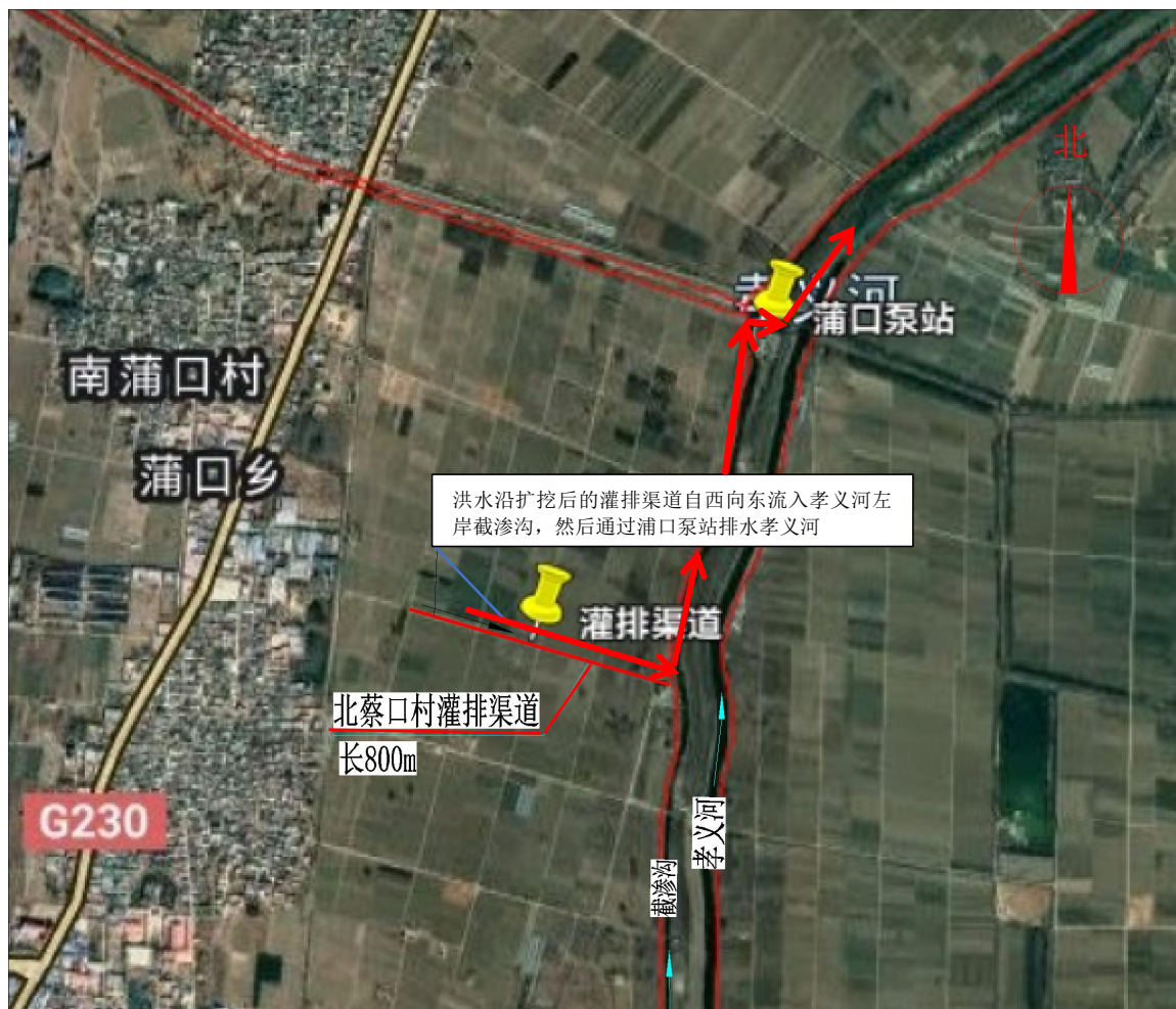
图8.1-8 扩挖灌排渠道洪水流向示意图
