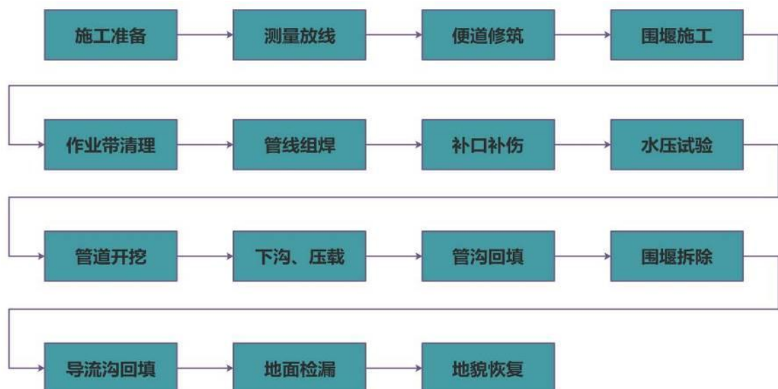
图 2.5-10 水塘开挖施工工艺流程图
