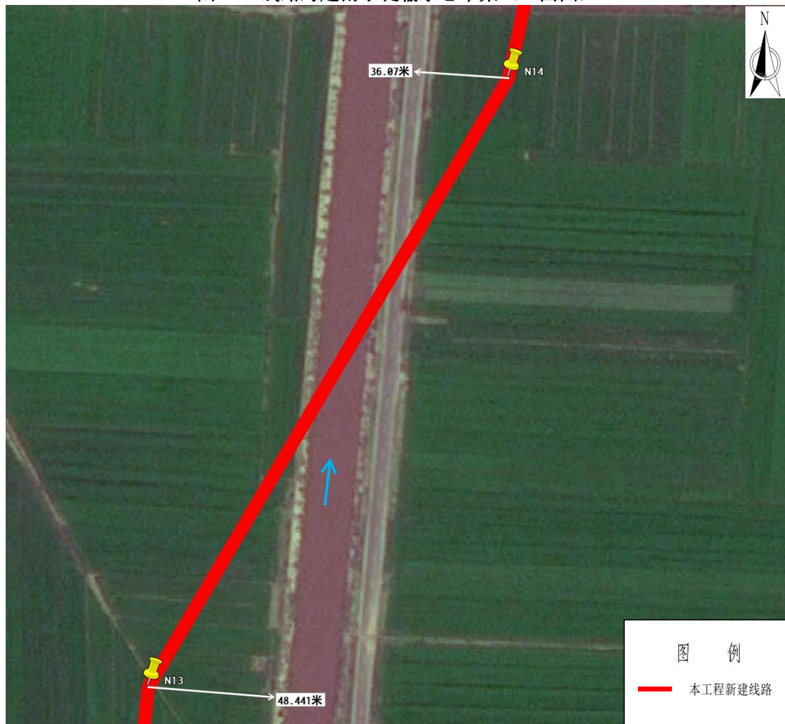
图3.9 线路跨越南小堤输水总干渠（平面图）
