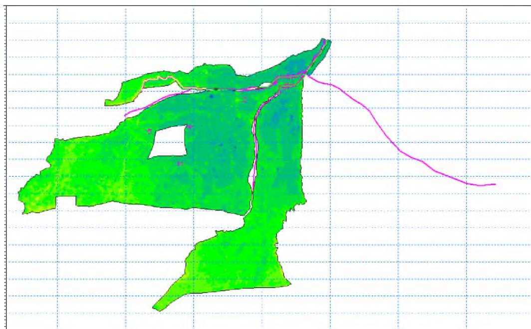
图 4.1-10 西三洼一维河网与二维网格连接示意图
