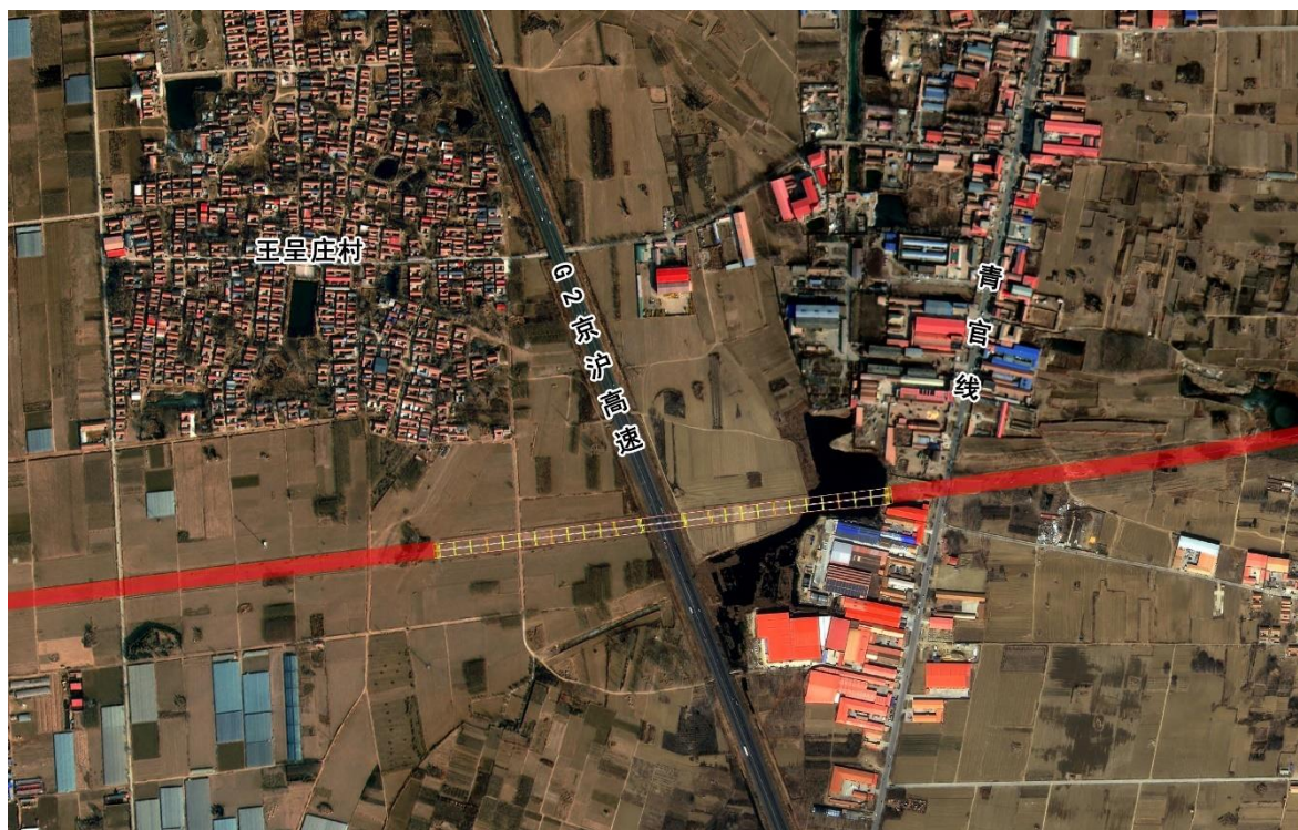
图 2.1-3 跨京沪高速公路大桥布置示意图
