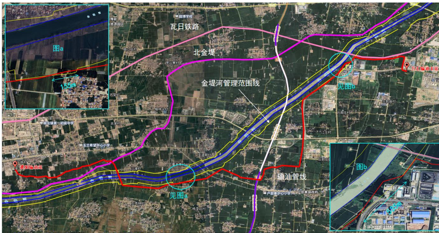
图 2.2-11 管道与金堤河管理范围关系图
