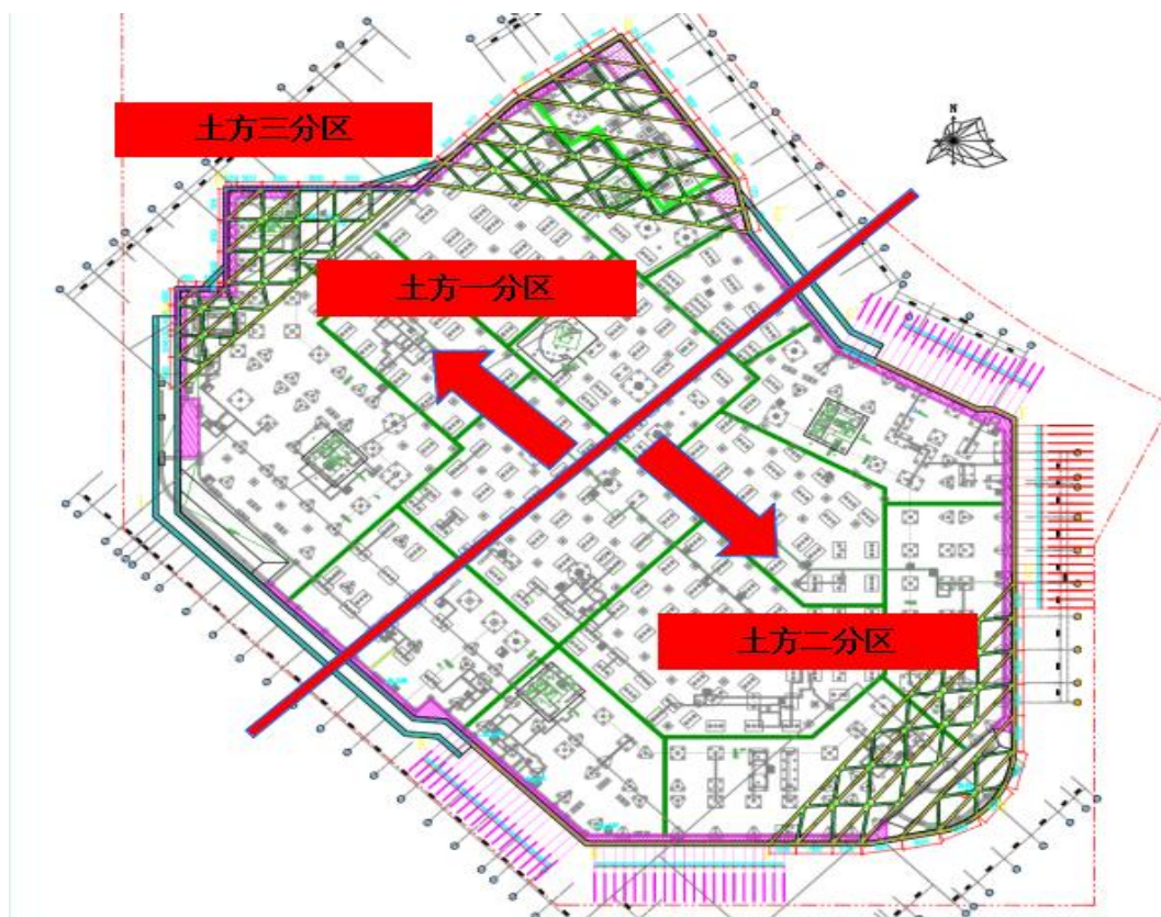
图 2.2-7 土方开挖分区平面图
