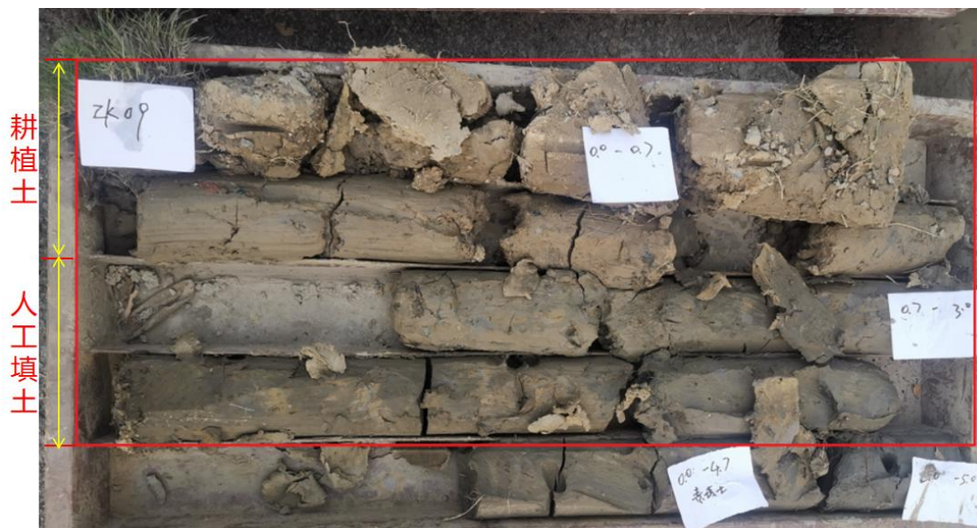
图 2.4-4 项目区岩土工程勘察报告钻孔取土情况
