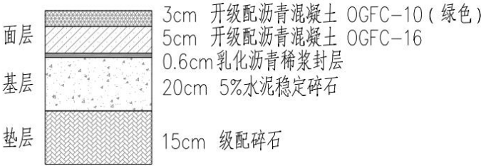
图 2.1-13 路面结构示意图
