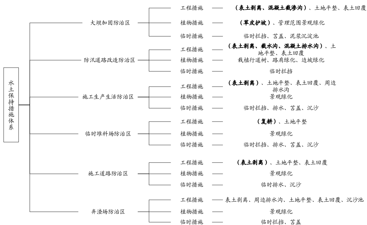
图 6.4-1 陆水水库除险加固工程水土保持措施总图布局图
