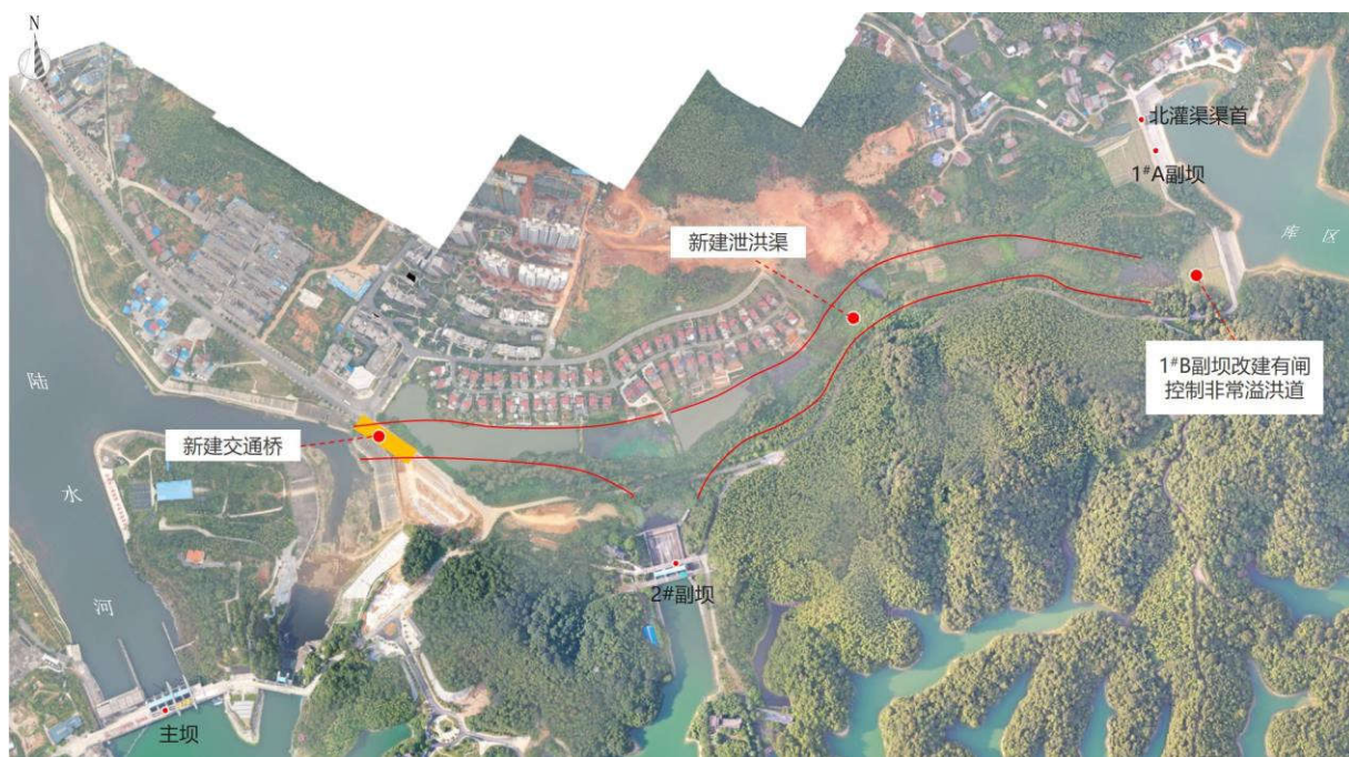
图 2.1-4 枢纽防洪能力达标加固工程平面布置示意图
