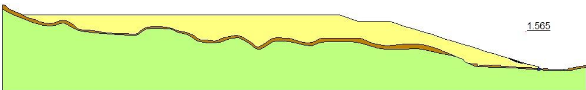
图 7.4-23 四棵树沟弃渣场正常运用工况边坡稳定计算结果图
