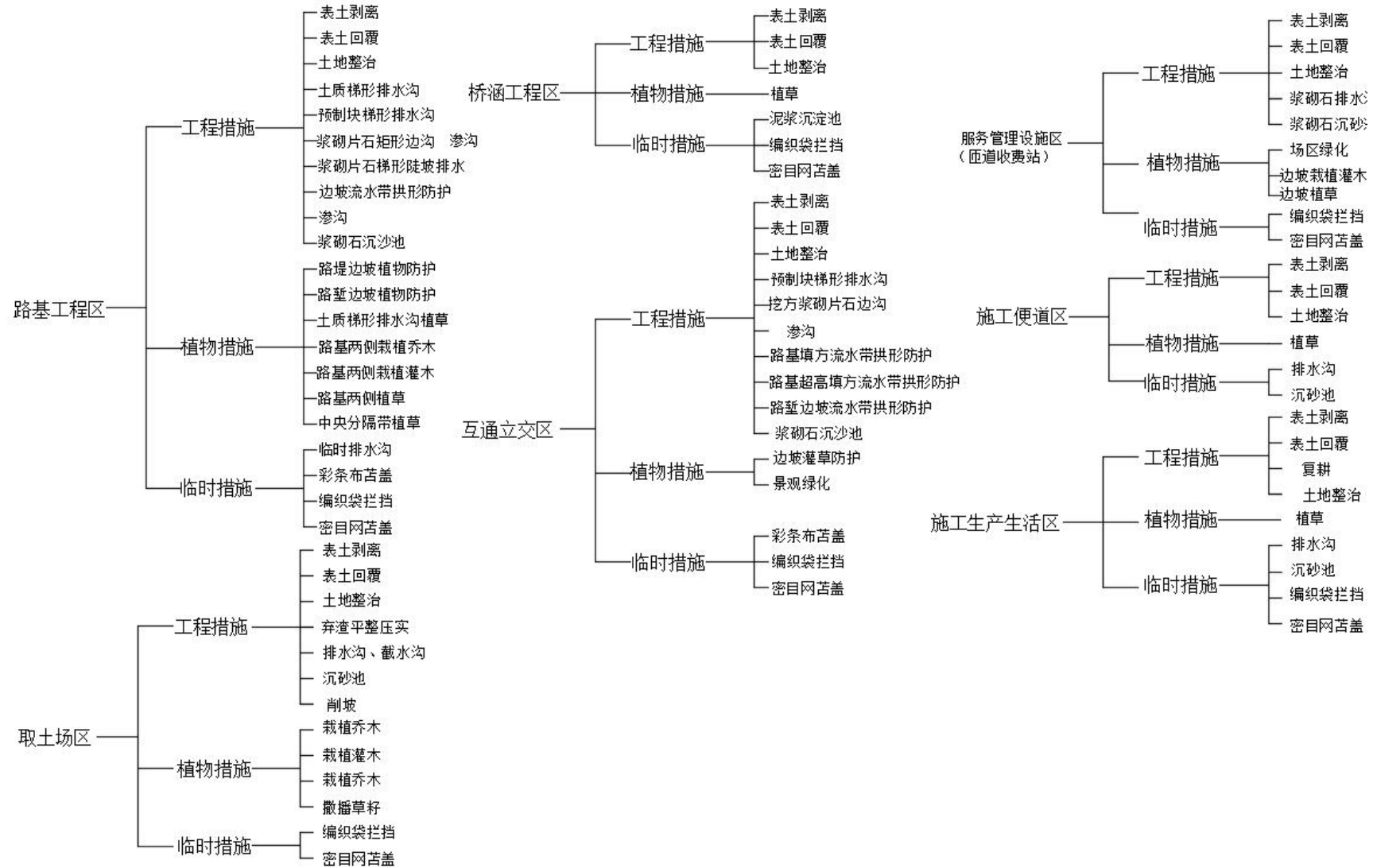
图 5.2-1 水土流失防治措施总体布局图（一）
