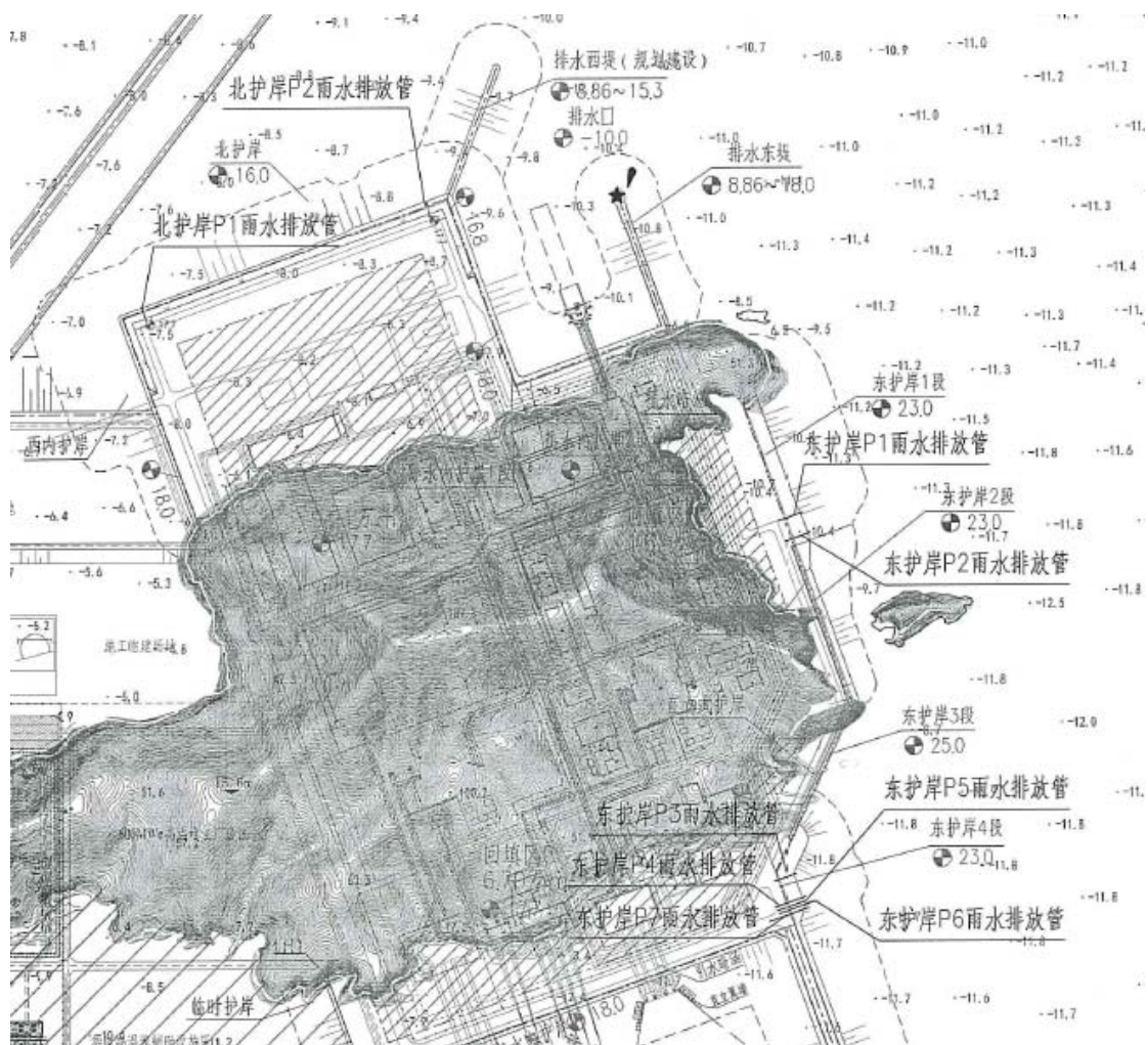
图 2.1-3 雨排系统入海口平面布置图
