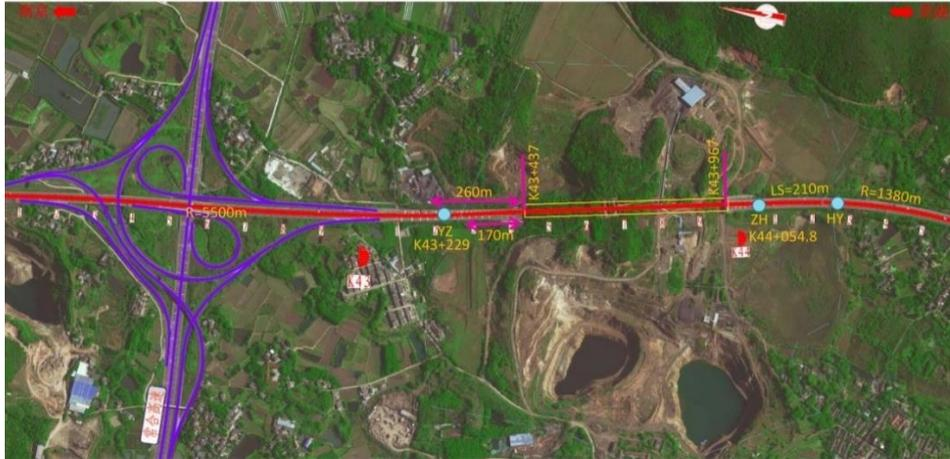
图 2.1.3-14 黄梅山隧道段平面指标示意图
