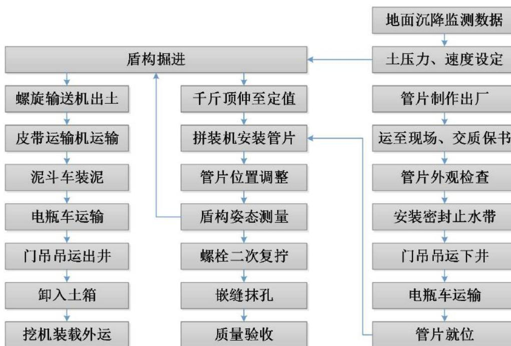
图 2.2-6 盾构机掘进工艺流程图
