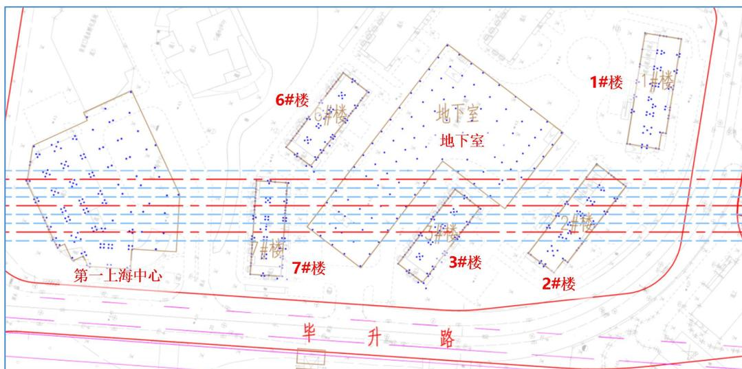
图 2.1-5 拔桩区域平面示意图
