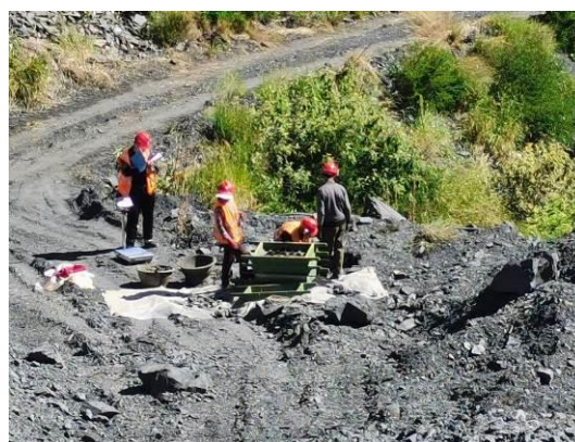
图 4-4 日阿额隧道支洞渣场上部堆渣体取样
