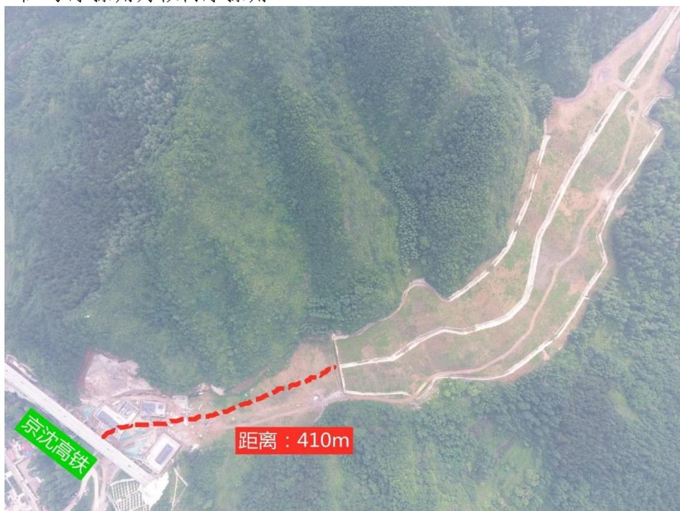
渣场下游 410m 为京沈桥梁，挡墙处高程 650m，桥梁处高程 618m，坡度 7.8%。
