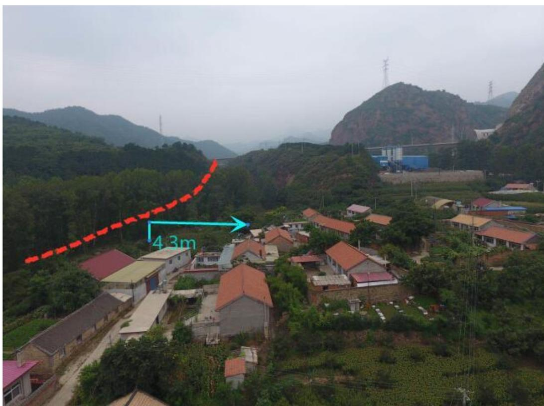
渣场下游 601m 为居民点，渣场不直冲居民点，挡墙处高程 638m，下游沟道平均坡度 6.8%，居民点在沟岸上，高程 597m，居民点与渣场所在沟道的沟底高差为 4.3m。
