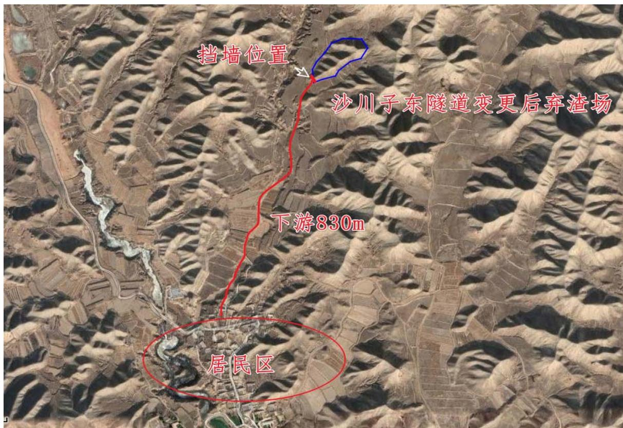
图 3.2-4.1 沙川子东隧道变更后弃渣场下游位置关系
