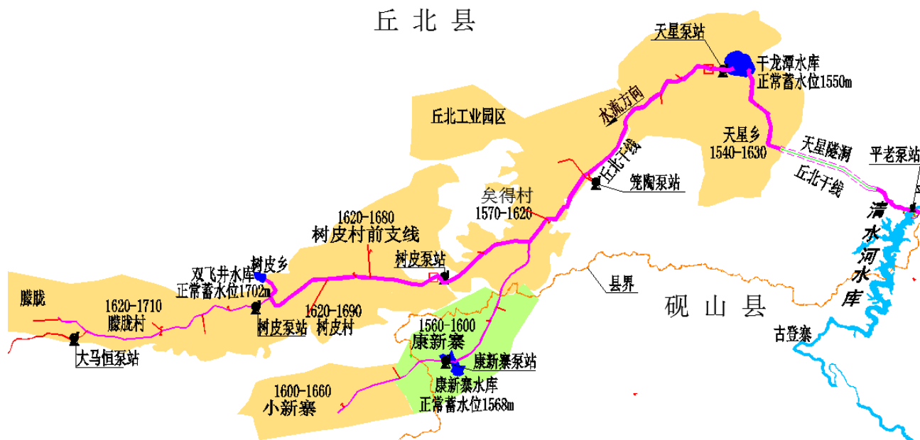
图 2.1-2 丘北方向线路及受水区(点)分布示意图
