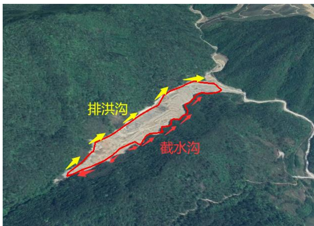
图 3.2.2-4 竹口弃土场排水系统设置示意
