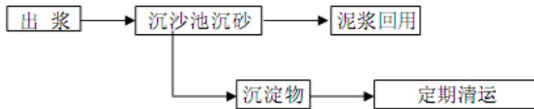
图 2-23 泥浆处理流程
