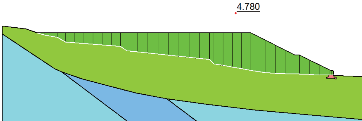
图 7.4-21 Y2#弃渣场非常运用工况 II 整体稳定计算结果简图
