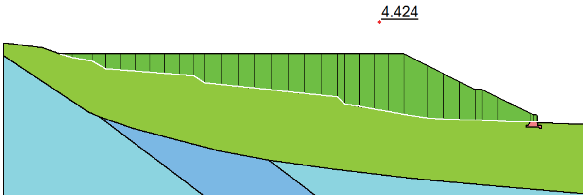
图 7.4-22 Z3#弃渣场正常运用工况整体稳定计算结果简图
