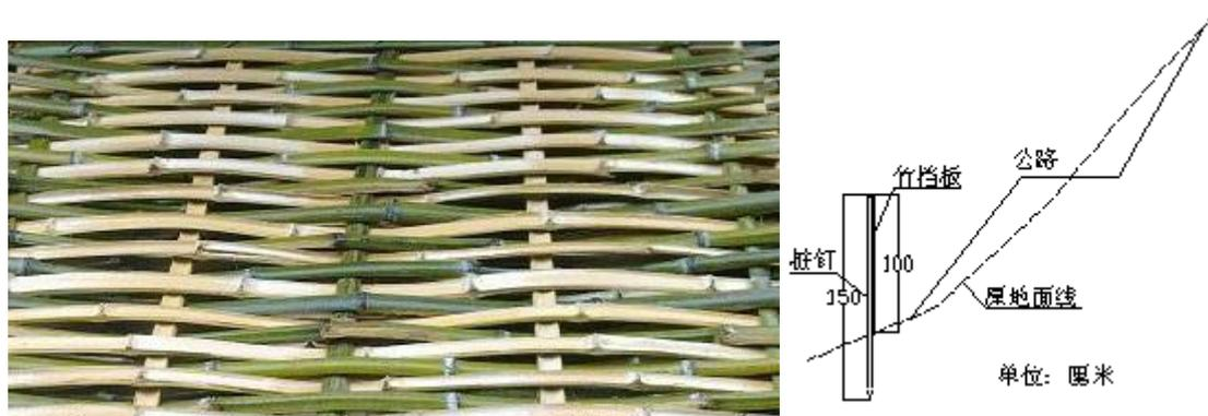
图 9.5.1 道路施工竹挡板及布置示意图
